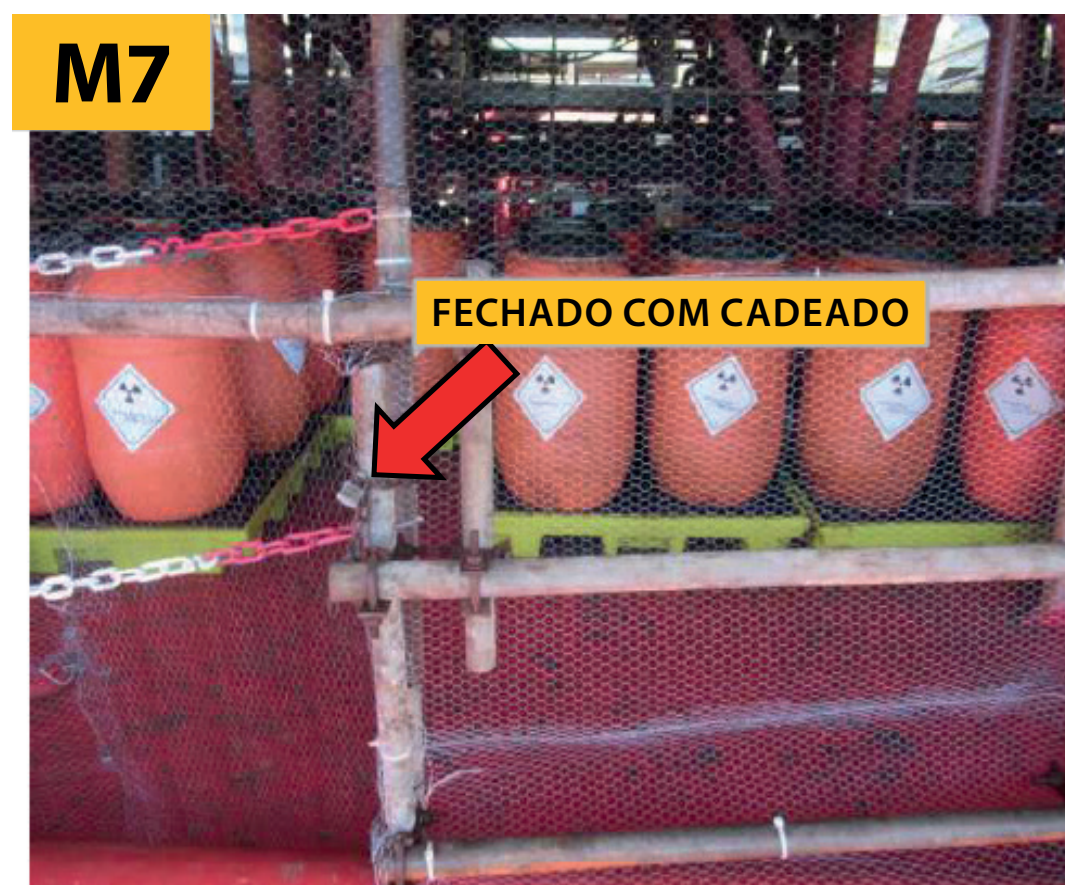
Figura 11: Exemplo de armazenamento de tambores a bordo da unidade marítima.
