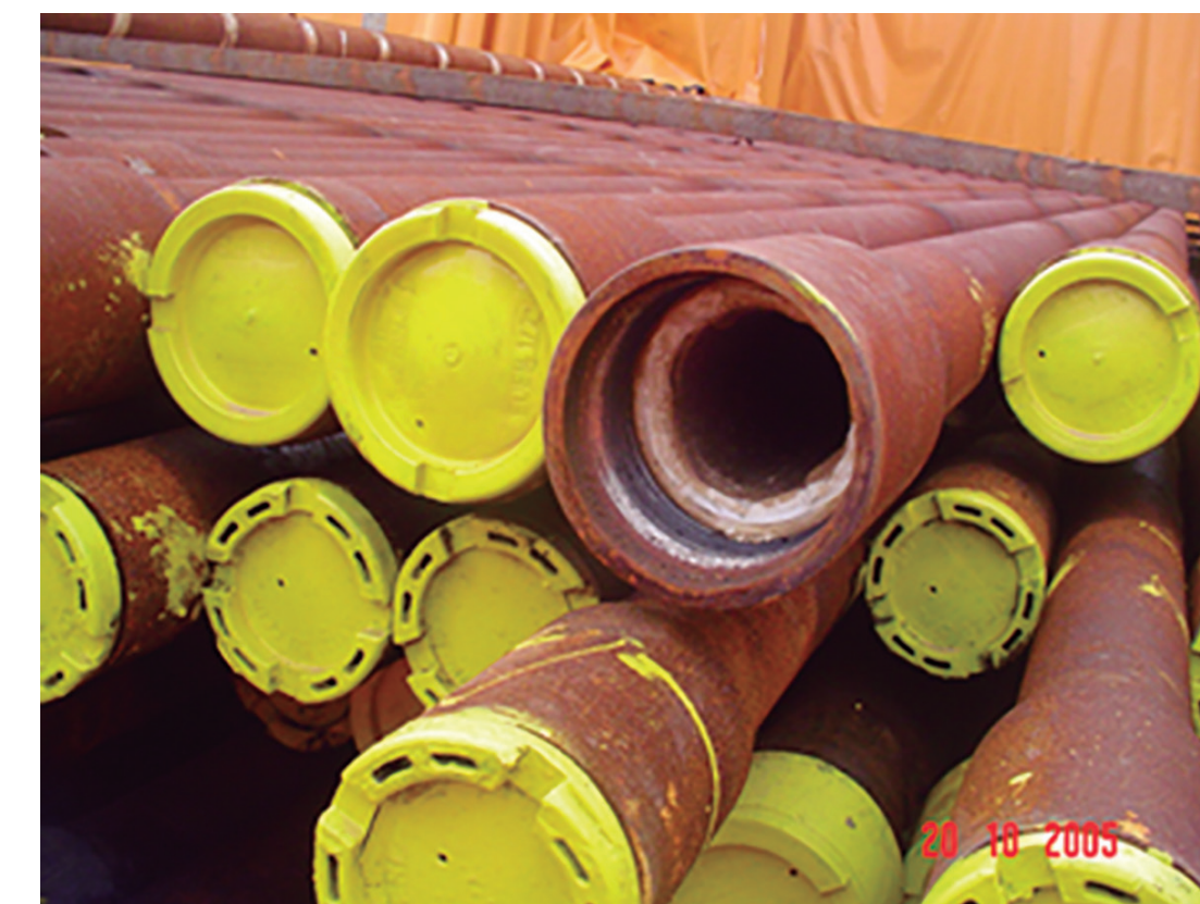
Figura 10: Exemplo de tubulação com incrustação fechada com protetor.
