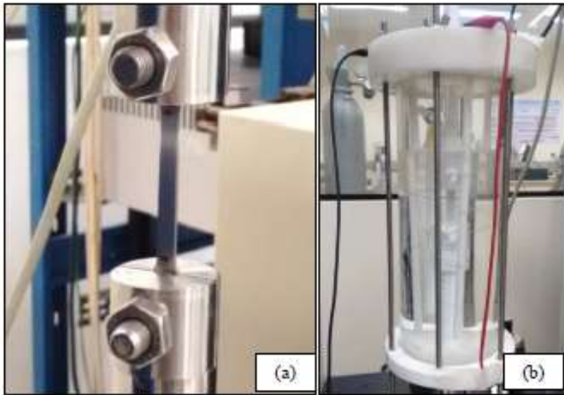
Figura 105 – Ensaio de tração em baixa taxa de deformação. Em (a), teste no material como recebido. Em (b), teste realizado sob corrente catódica em célula de hidrogenação.
