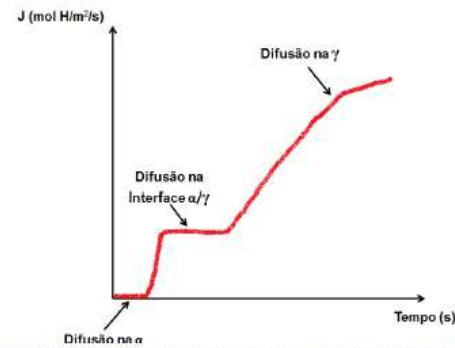
Figura 124 – Esquema representando o comportamento duplo-sigmoidal no AISD HIP em altas temperaturas de teste.
